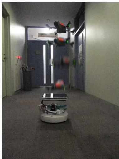
図 7.1: 地上用小型無人移動体から飛び立つ空中用小型無人移動体
