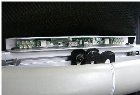
図 2.20: AT に搭載されている赤外線 LED
