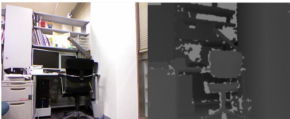
図 2.4: Kinect のセンサーデータ
