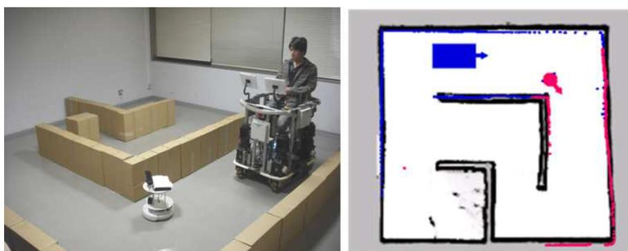
図 4.15: 注意区間で停止する SUV とその時の AT のコンソール画面
