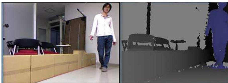
図 2.11: 深度センサーによる移動障害物の検出
