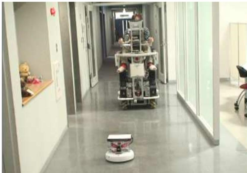
図 1.2: AT の経路上を先行して自動走行する SUV
