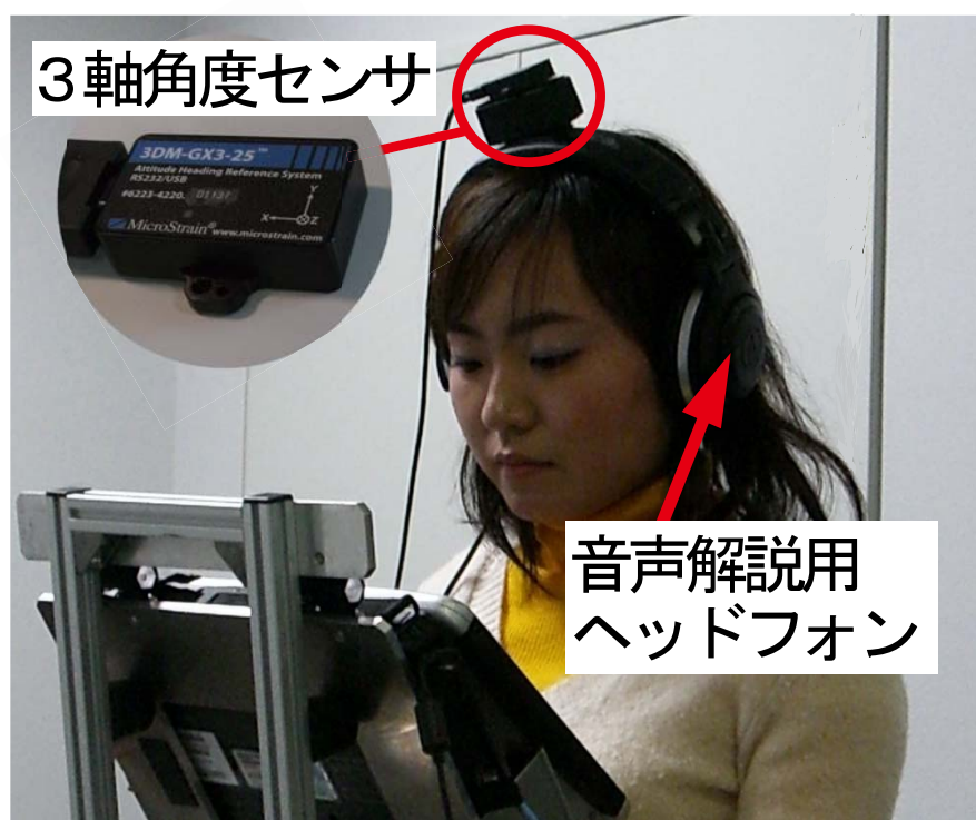
図 4.1: 搭乗者が装着するヘッドフォンと3軸角度センサ
