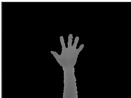
図 3.4: Xtion からの距離で制限した深度情報
