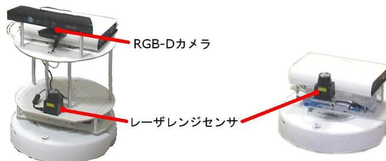
図 5.3: 2種類のSUV(左:RGB-Dカメラ搭載, 右:RGB-Dカメラ非搭載)
