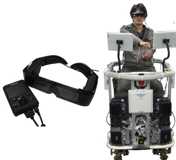
図 5.1: 透過型ヘッドマウントディスプレイ (左) と装着して AT に搭乗した様子 (右)
